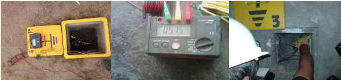
Este procedimiento de mantenimiento de Pozo a Tierra Básico se aplica a los Pozos a Tierra que han tenido un mantenimiento regular cada año y que cuentan con Protocolo de Pruebas de Pozo a Tierra con una Lectura del ohmiaje igual o menor a 25 ohmios.
